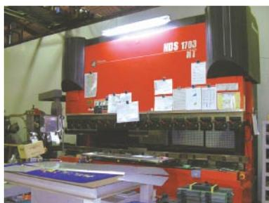
にレーザー加工機、ペンディングマシン（写真）などで「切る・曲げる・穴あけ・絞る」などの工程を経て、昼過ぎ納入、しかも数は 1 個、というような離れ業を
